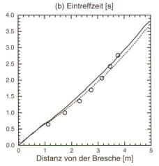
Bild 4. Beobachtete und berechnete Abflusshöhen (a) und Eintreffzeiten (b) für die Versuchsanlage von Broich et al. (1993).
