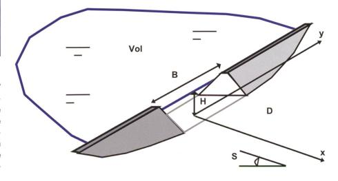
Bild 1. Abfluss aus einer Bresche auf einer geneigten Fläche: massgebende Parameter und Lage der Koordinatenachse.
