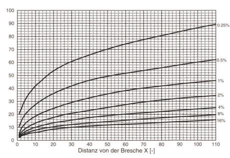
Diagramm B. Laterale Ausbreitung des Abflussstrahles für verschiedene Sohlengefälle.
