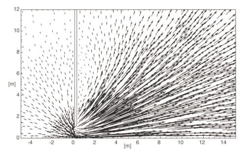
Bild 2. Berechnete Vektoren der Fliessgeschwindigkeit im Breschenbereich für eine Breschenbreite B = 2 m, Stauhöhe H = 1 m und Sohlengefälle 0,5%. Berechnet und dargestellt wird nur eine Symmetriehälfte. Ersichtlich ist der laterale Zufluss im Speicher, die Einschnürung des Strahles im Breschenquerschnitt sowie die Ausbreitung des Strahles in der Ebene verbunden mit der Ablösung und der Zirkulationszone.
