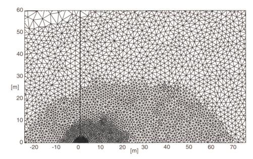
Bild 3. Verwendetes Berechnungsnetz für Dammbruchberechnung (Ausschnitt). Modelliert wird nur eine Symmetriehälfte. Die Bresche befindet sich bei x = 0 und ist 1 m breit. Die Fläche der Zellen variiert zwischen 100  $m^2$  (Fernbereich) und 0,1  $m^2$  (Breschennahbereich).
