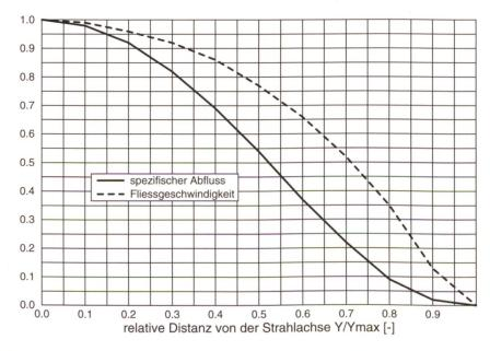
Diagramm C. Charakteristische Querprofile der Abflussintensitäten.
