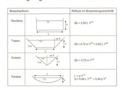
Bild 2. Abflussmengen in der Bresche im Moment des Bruchs für verschiedene Formen des Breschenquerschnitts nach [2].
