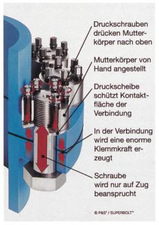
Bild 2. Anwendung von Superbolt<sup>®</sup>-SVS zur Verschraubung der Peltondüsen im Kavernenkraftwerk Bieudron.
