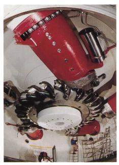
Bild 1. Superbolt®-Spannsystem mit Vielfachschrauben (SVS).
