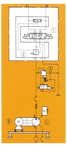
Bild 7. Beispiel Volumenstromsteuerung mit Proportionalsystem mit ① Proportionalventil, ② Druckwaage, ③ druckloser Umlauf, ④ Verstellpumpe mit Druckregler, ⑤ E-Motor.
