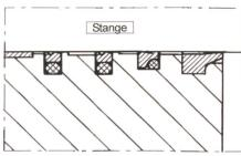
Bild 5. Stangendichtung mit Nutringdichtung.
