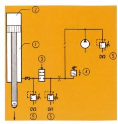
Bild 6. Drucküberwachung mit ① Ringraum unter Last, ② Kolbenraum des Zylinders, nicht beaufschlagt, ③ Sperrventil,
