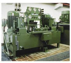
Bild 9. Hydraulikaggregat als Kompaktausführung.
