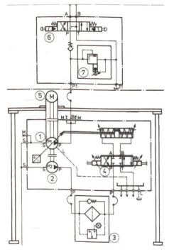
Bild 8. System mit Verstellpumpe, mit
