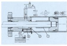
Bild 2. Detailansicht der Dämpfung mit
