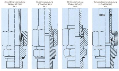
Bild 15. Status der ISO-Standardisierung (Rohrverschraubungen ISO 8434).
