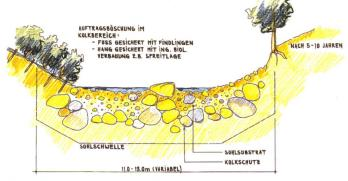
Bild 9. Querprofil zwischen den Sohlschwellen.
