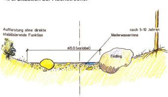
Bild 6. Schematisches Querprofil der Flachstrecke.
