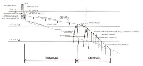
Bild 4. Längenprofil des bestehenden und neuen Bachbetts und der Kalotte der beiden Tunnelröhren (ca. 1:10 überhöht).
