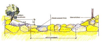
Bild 8. Querprofil der Sohlschwelle.
