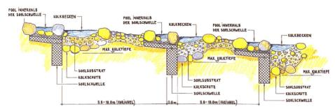
Bild 10. Längenprofil durch Steilstrecke mit Sohlschwelle.
