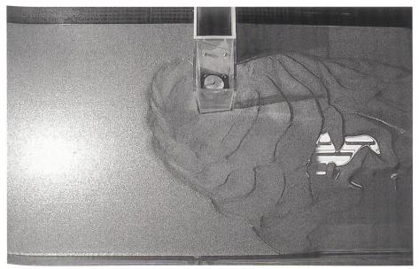
Bild 2.Widerlagerkolk-Experiment 28. September 1999, d<sub>50</sub>=0,55 mm, F<sub>d</sub>=2,0, h<sub>o</sub>=20 mm.
