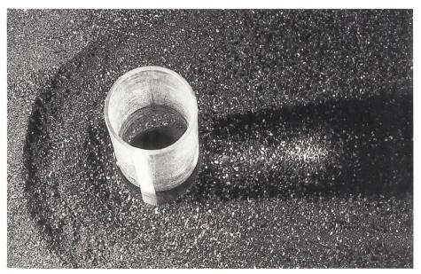
Bild 1. Pfeilerkolk-Experiment 2. März 2000, Mischung 2, h<sub>o</sub>=20,2 cm, F<sub>d</sub>=2,4.
