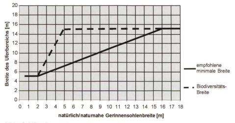
Bild 4. Schlüsselkurven für den Raumbedarf.
