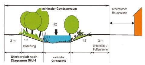
Bild 2. Minimaler Raumbedarf aus der Sicht Hochwasserschutz.
