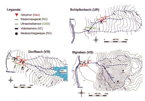
Bild 2. Übersicht über das Wildbach-Einzugsgebiet und die Art der Instrumentierung bei den Murgang-Beobachtungsstationen.
