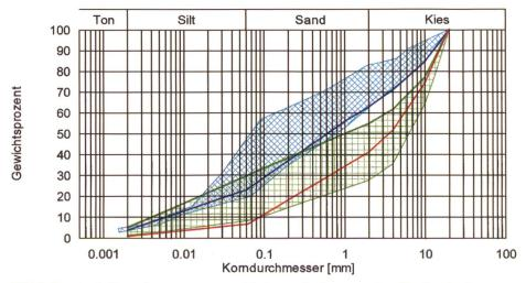
Bild 6. Kornverteilungskurven von verschiedenen Proben aus dem Dorfbach, dem Illgraben und dem Schipfenbach. Die schraffierten Flächen zeigen den Streubereich von «n» verschiedenen Proben. Für den Illgraben und Schipfenbach sind zusätzlich Kurven von Murgangereignissen im Jahr 2000 dargestellt.
