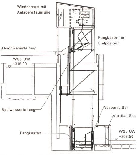
Bild 3. Schnitt durch den Fischlift.
