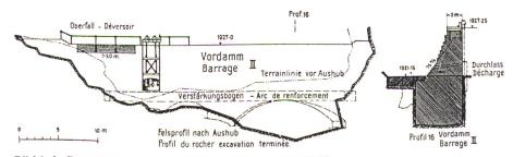
Bild 1. Aufbau des Vordammes II, Ausgleichsbecken Palü.
