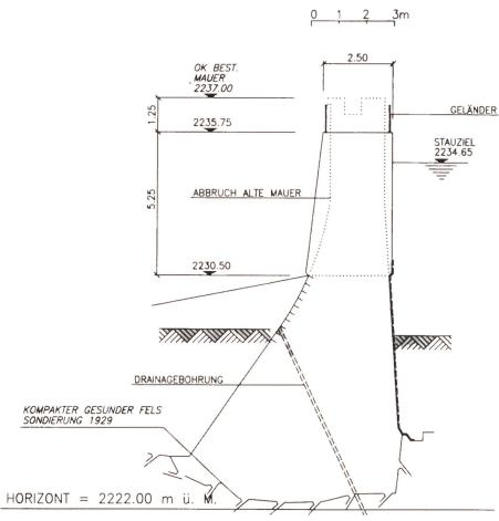
Bild 2. Sanierung des Ost- und Mittelbogens.
