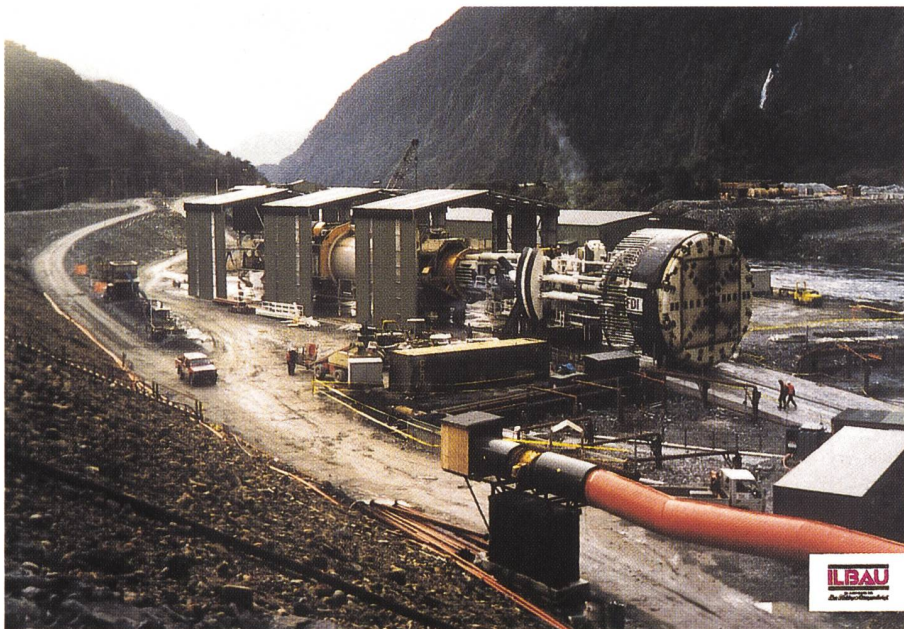
Bild 1. Offene Hartgesteins-Tunnelbohrmaschine mit 10 m Bohrkopfdurchmesser und Nachläufer.
