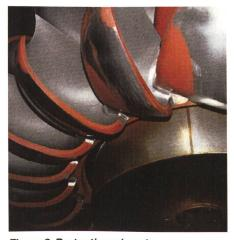
Figure 8. Protection céramique roue Pelton Bitsch.
