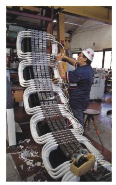
Bild 6. Die neue Generatorstatorwicklung wird in aufwendiger Handarbeit in die Nuten eingelegt.
