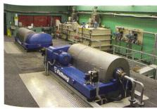
Bild 1. Flottweg-Hochleistungszentrifugen.
