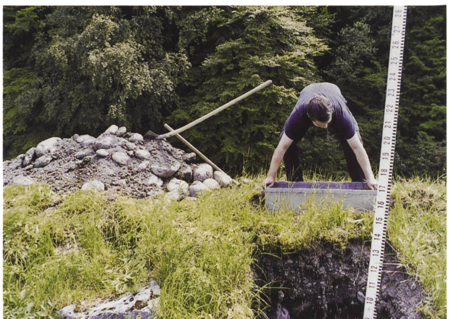
Bild 3. Baggerschlitze, Entnahme von Bodenproben und Versickerungsversuche an Hochwasserschutzdämmen, Lütschine, Wilderswil, 1999.
