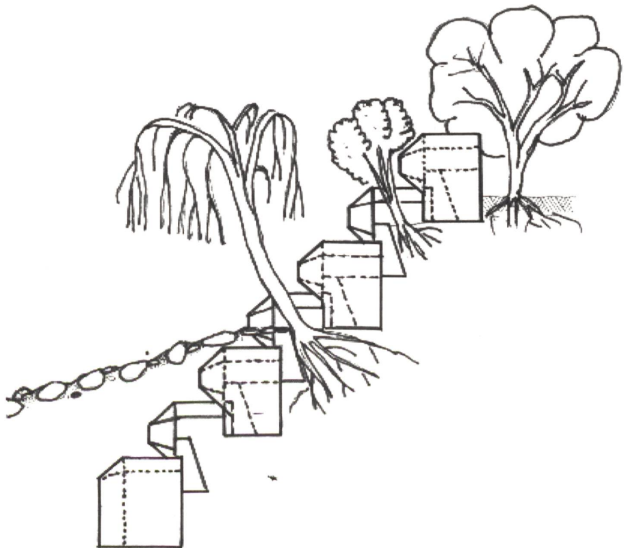
Bild 13. Blockmauer aus an Ort erstellten, unarmierten Betonblöcken ( 1 \text{ m}^3 ) mit Lücken für Bewuchs (gemäss Dénes [5]).
