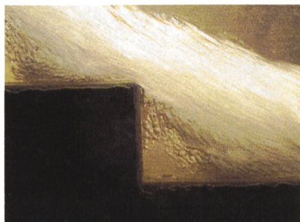
Figure 3. «Skimming flow» sur un escalier. (André, S., LCH 1999)
