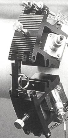
*Einfach und schnell von außen auf das Rohr aufzusetzende Messköpfe!*
