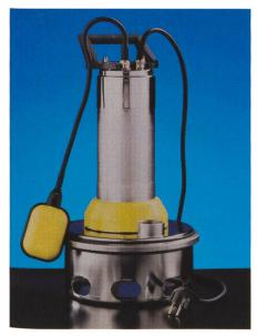
Der in die Motorwicklung integrierte Bimetallschalter schützt die Pumpe vor zu starker Wärmeentwicklung. Kurzzeitig kann sogar 90 °C heisses Schmutzwasser gefördert werden, wie es etwa bei einem Kochwaschgang in einer Waschmaschine anfällt.
