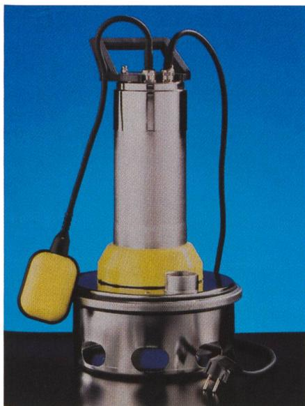
Der in die Motorwicklung integrierte Bimetallschalter schützt die Pumpe vor zu starker Wärmeentwicklung. Kurzzeitig kann sogar 90 °C heißes Schmutzwasser gefördert werden, wie es etwa bei einem Kochwaschgang in einer Waschmaschine anfällt.
