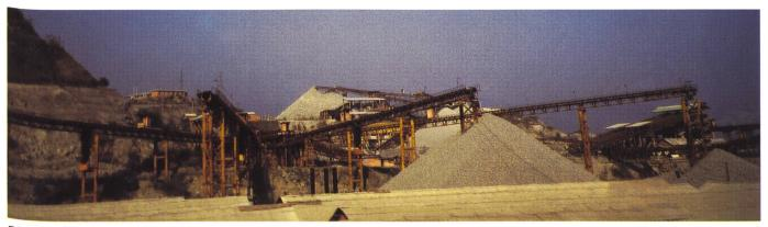
Bild 6. Aufbereitungsanlage für Betonzuschlagstoffe im Baustellenbereich.
