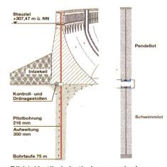
Bild 1. Vertikale Lotbohrungen in der Staumauer der Ennepetalsperre.
