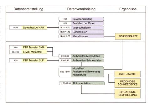
Bild 3. Verarbeitungsschritte vom Empfang der Satellitendaten und der Prozessierung der Schneekarte bis zur Erzeugung der Karten des Schneewasseräquivalents und der Schneedeckenprognose. Die linke Spalte kennzeichnet die erforderlichen Dateneingaben, die mittlere Spalte umfasst die Verarbeitungsschritte und die rechte Seite enthält die schlussendlich an Geo7 weitergeleiteten Resultate.
