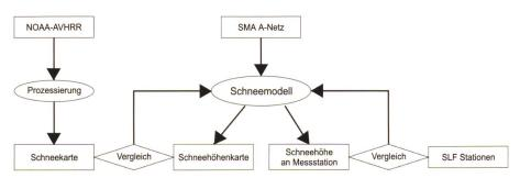
Bild 1. Verknüpfung der Fernerkundungsdaten und Schneehöhenmessungen mit dem Schneedeckenmodell.
