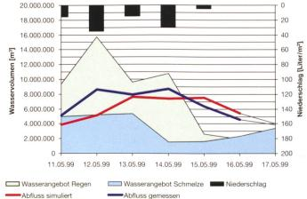
Bild 4. Simme – Oberwil: Nachsimulation mit den gemessenen Meteoparametern für die Periode 11. bis 17. Mai 1999. Simulierter und gemessener Abfluss stimmen wesentlich besser überein. Die Verzögerung im Anstieg des Abflusses um einen Tag ist auf die Simulation in Tagesschritten zurückzuführen.
