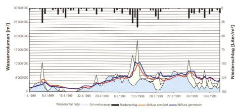
Bild 8. Kontrollsimulation 1. April bis 15. Juni 1999 mit gemessenen Meteodaten. Gegen Ende der simulierten Periode werden die Abflüsse etwas unterschätzt. Dies ist auf eine Unterschätzung des Wasseräquivalents zu Beginn der Simulation zurückzuführen.
