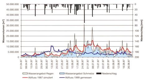
Bild 5. Szenario «Kander – Hondrich 87» (Witterungsverlauf analog 1987). Durch den kühlen Frühling wird die Schneeschmelze stark verzögert. Die intensive Schneeschmelze im Juli lässt, zusammen mit Starkniederschlägen, den Abfluss auf ein Niveau ansteigen, das deutlich über demjenigen von 1999 liegt.
