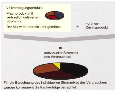
Bild 3. Vorgeschlagenes Kontrakt-Modell für die Ökobilanzierung von Elektrizität auf der Ebene der Verbraucher: Die einzelnen Produkte werden zu einem individuellen Elektrizitätsmix zusammengefügt. Bilanziert wird über den Zeitraum eines Jahres.
