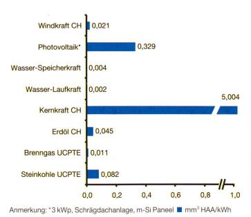
Bild 2. Hochaktive Abfälle (HAA) verschiedener Stromproduktionstechnologien. Quelle: Frischknecht et al. (1996). dem Verhältnis der verschiedenen Produktionstechnologien innerhalb des Poolgebietes bilanziert
