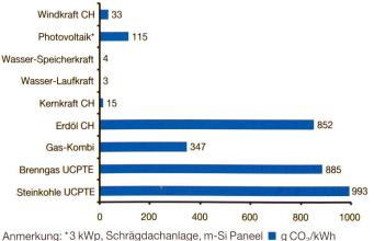
verschiedener Stromproduktionstechnologien. Quelle: Gas-Kombi: Frischknecht (1998); übrige: Frischknecht et al. (1996).
