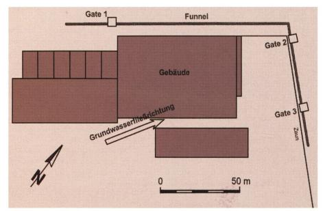
Bild 1. In-situ-Grundwasserreinigung nach dem Funnel-and-Gate-System in Tübingen (Lageplan).
