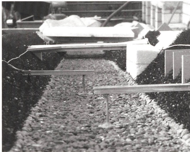
Bild 6. Modellversuche zum selektiven Schwemmholzurückhalt mit versetzten horizontalen Balken am Riemenstalderbach/Uri (Blick in Fließrichtung mit den verklausungsgefährdeten Brücken im Hintergrund).
