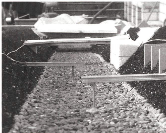
Bild 6. Modellversuche zum selektiven Schwemmholzrückhalt mit versetzten horizontalen Balken am Riemenstalderbach/Uri (Blick in Fließrichtung mit den verklausungsgefährdeten Brücken im Hintergrund).
