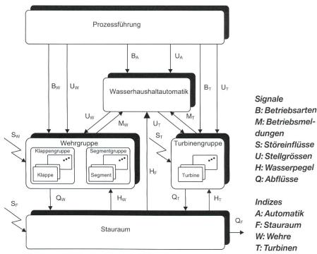
Bild 2. Modell eines Laufkraftwerkes mit Matlab Simulink [6].
