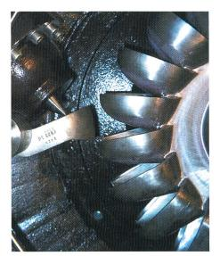
Bild 3. Blick von unten auf das Turbinenlaufrad und auf eine der fünf Düsen mit dem Strahlablenker.
