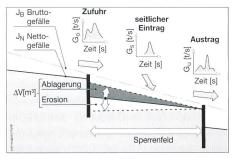
Bild 3. Geschiebebilanzierung innerhalb eines einzelnen Sperrenfeldes.
