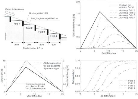
Bild 4. Anwendungsbeispiel für das Simulationsprogramm «Treppe».
