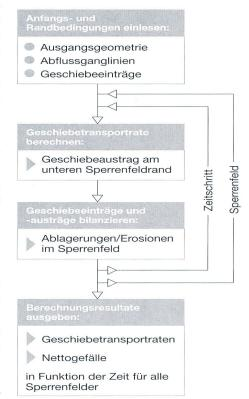
Bild 2. Simulationsablauf beim Programm «Treppe» für einen Bachabschnitt.
