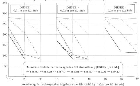
Bild 3. Maximale Änderung der Abgabe an die Sihl.
