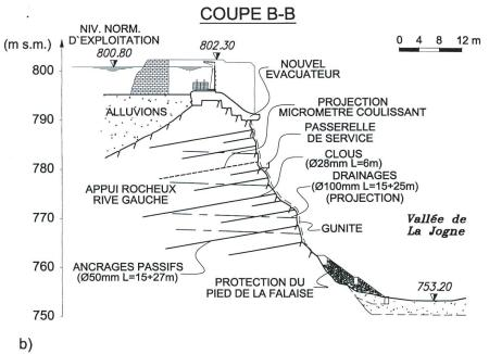
Figure 6. Appui en rive gauche, mesures de confortement a) vue générale, b) coupe.
