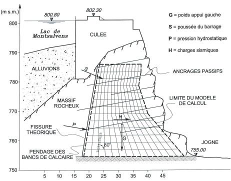
Figure 7. Appui rive gauche, section type au droit de la culée en rive gauche avec sa modélisation pour les calculs numériques (modèle l).
