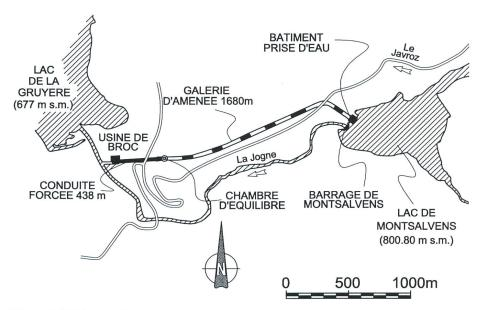
Figure 1. Schéma de l'aménagement de Montsalvens.
