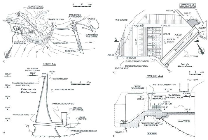
Figure 4. Barrage de Montsalvens tel qu'il se présentait avant les travaux d'assainissement, a) vue en plan, b) section en clef de voûte. Figure 5. Evacuateur en rive gauche après les travaux de renouvellement a) situation, b) coupe.
