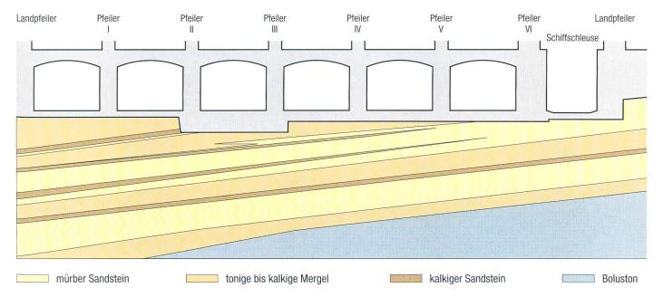
Bild 3.2. Geologie der Wehrfundation.
