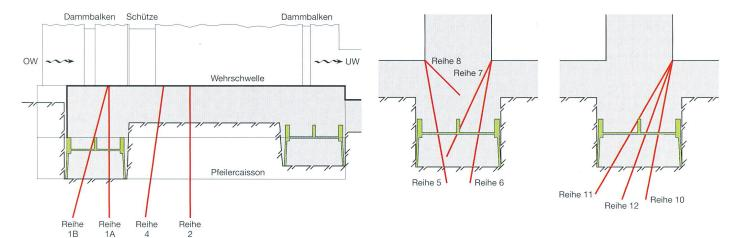
Bild 4.4, links. Längsschnitt durch Wehrpfeiler mit Injektionsreihen 1, 2 und 4. Bild 4.5, rechts. Querschnitt durch Pfeiler und Injektionsreihen 5, 6, 7, 8, 10, 11 und 12.
