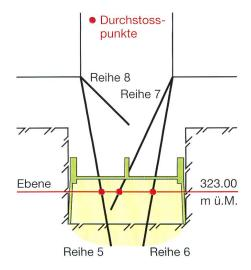
Bild 6.3. Definition der Durchstosspunkte.
