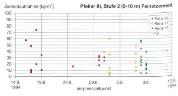
Bild 6.1. Zementaufnahmen (in kg/m¹) als Funktion des Verpressdatums. Bild 6.2. Zementaufnahmen in den Reihen 10, 11 und 12 sowie der Kernbohrungen.
