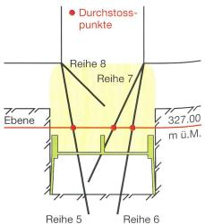
Bild 6.12. Definition der Durchstosspunkte für den Pfeilerunterbau.
