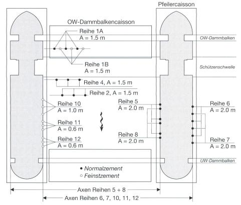
Bild 4.3. Grundriss einer Wehröffnung und Anordnung der Injektionsreihen.
