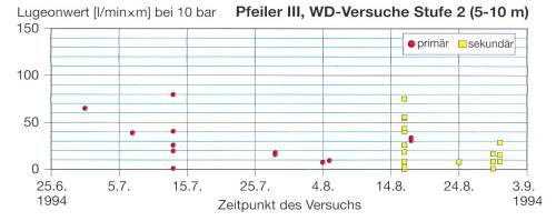
Bild 6.6. WD-Ergebnisse vor der Injektion und nach der Injektion primärer und sekundärer Hohlräume als Funktion des Versuchsdatums.
