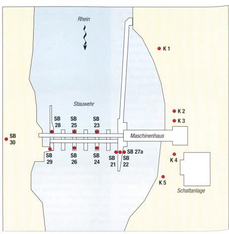
Bild 3.1. Lage der Kernbohrungen des geologisch-geotechnischen Untersuchungsprogrammes.
