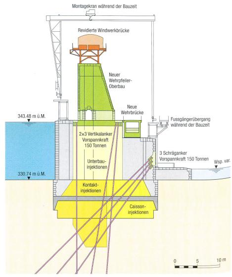
Bild 1.3. Querschnitt durch einen Wehrpfeiler und Sanierungsmassnahmen.
