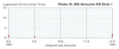
Bild 6.14. Ergebnisse der WD-Versuche nach Abschluss der Injektionen.
