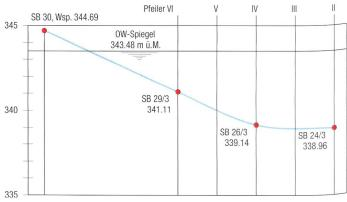
Bild 3.4, links. Wasserdruckverteilung in den Pfeilerfundationen.
