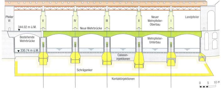
Bild 1.2. Ansicht der Wehranlage vom Unterwasser.
