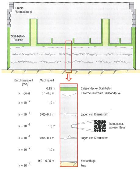
Bild 4.1. Modell der Hohlräume in der Fundation der Wehrpfeiler.
