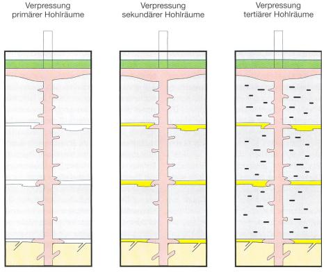
Bild 4.2. Schematische Darstellung des Verpressvorganges.
