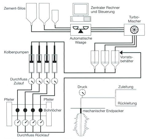
Bild 5.1. Schematischer Layout der Injektionsinstallationen.
