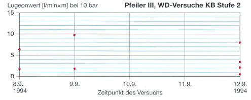
Bild 6.7. Ergebnisse der WD-Versuche nach Abschluss der Injektionen.
