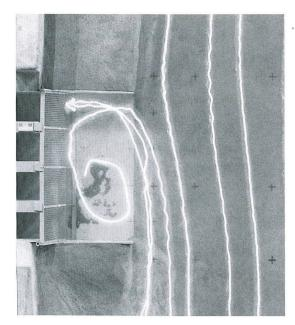
Figure 6. Lignes de courant et vitesses superficielles pour un débit du Rhône de 100 m3s-1 et un soutirage de 2,5 m<sup>3</sup>s<sup>-1</sup>; a) Modélisation numérique FLOW-3D, b) Lignes de courant superficielles sur modèle physique.
