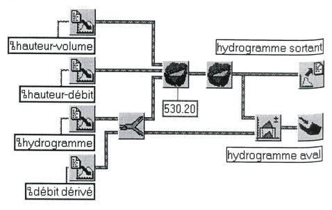
Figure 3. Schéma de modélisation de deux bassins en dérivation parallèle, avec le programm RS.
