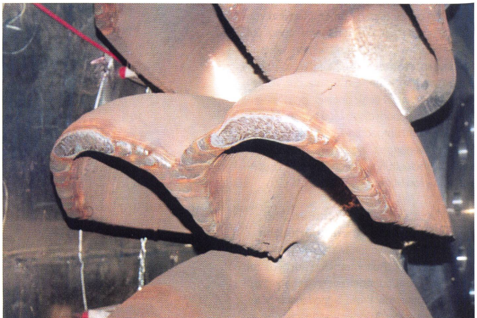
Bild 6. Die durch Schweissen aufgetragenen Becher vor der Bearbeitung (MicroGuss®).
