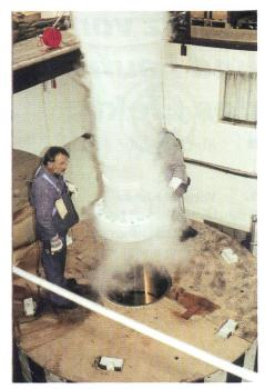
Bild 4. Einfahren der abgekühlten Welle in den Rotorstern.
