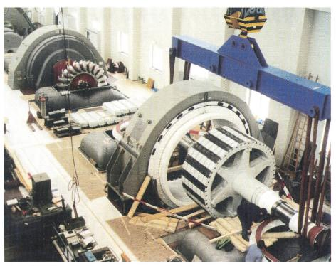
Bild 2. Ausfahren des Rotors.
