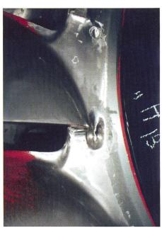
Bild 5. Ausgeschliffene Risse an einem alten Laufrad.
