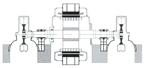
Bild 1. Längsschnitt durch eine Maschinengruppe des Kraftwerkes Tinizong.
