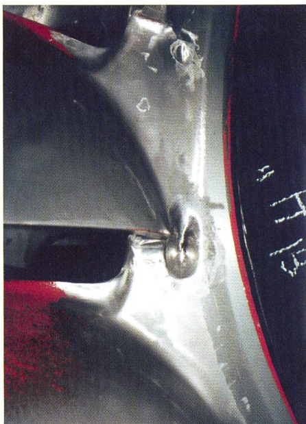
Bild 5. Ausgeschliffene Risse an einem alten Laufrad.
