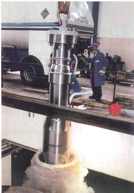
Bild 3. Abkühlen der Welle in einem Bad aus flüssigem Stickstoff auf -195\text{ }^{\circ}\text{C} .
