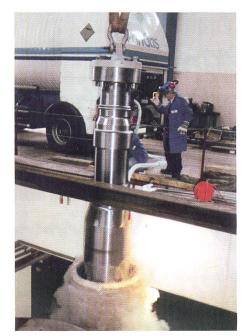
Bild 3. Abkühlen der Welle in einem Bad aus flüssigem Stickstoff auf –195°C.
