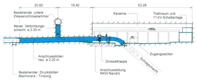
Bild 13. Längsschnitt Anschlussstollen und Kaverne.
