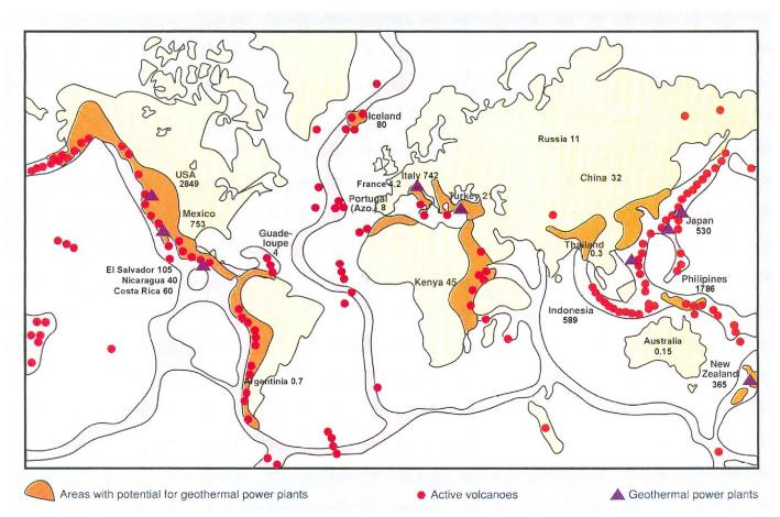
Bild 1. Weltweit installierte Leistung (in MW) zur geothermischen Stromerzeugung (Stand 1997).
