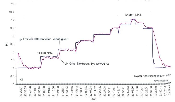
Bild 1. ph-Funktion der differentiellen Leitfähigkeits-pH-Messung im Vergleich mit einer Glas-pH-Elektrode. pH-Variation durch kontinuierliche Addition von Ammoniaklösung in eine fliessende Reinstwasser-Probe.
