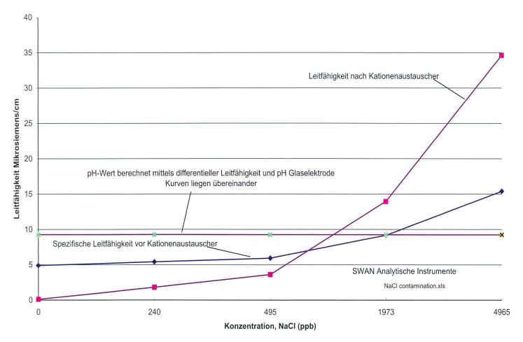
Bild 2. Der Einfluss von NaCl-Kontamination auf die pH-Messung mittels differentieller Leitfähigkeit.
