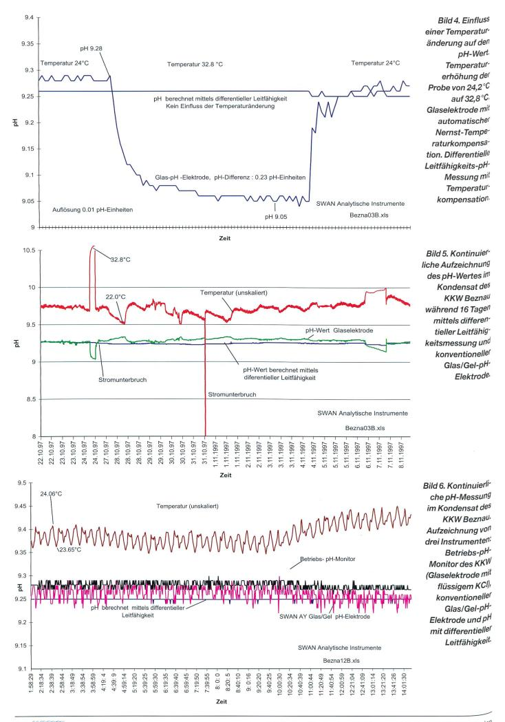
Alle Daten wurden über ein Feldbussystem übermittelt und auf einem PC protokolliert. In einzelnen der langfristigen Experimente wurden die 4 ... 20 mA-Instrumentenausgänge in den Kraftwerken auf eine 4-Kanal-Umwandlungseinheit (PAM Vicom) übermittelt. Sie ermöglichte die Umwandlung der Instrumentendaten auf das von Swan verwendete Feldbus-Protokoll. Dadurch konnten die Swan-Daten kontinuierlich mit den Daten der Betriebsinstrumente des Kraftwerks verglichen werden.
