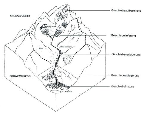
Bild 1. Schematische Darstellung eines Wildbaches (Kienholz et al., 1991).
