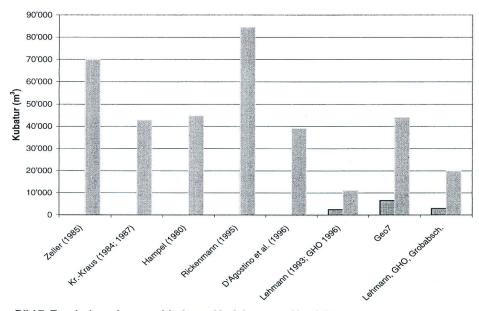
Bild 7. Ergebnisse der verschiedenen Verfahren zur Abschätzung der Feststoffkubatur im Steinibach, Kanton Luzern. Die Doppelwerte der beiden Verfahren GHO berücksichtigen verschiedene Szenarien. Der hohe Wert beim Verfahren Geo7 geht von einem Murgang aus, der tiefe Wert von einem geschiebeführenden Hochwasser.
