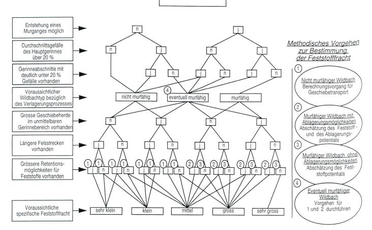
Bild 5. Diagramm zur Abschätzung der spezifischen Feststofffracht in Wildbächen (Lehmann, 1993a; GHO, 1996).
