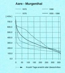
Abflussmenge der Aare bei Murgenthal. Einzugsgebiet 10 143 km². Vergletscherung 2,4%. Jahresabflussmenge 1935–1997 286 m³/s; Jahr 1997 265 m³/s.
