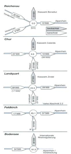
Bild 4. Geschiebebilanzen bei den Mündungen der Zuflüsse und beim Bodensee in m³ pro Jahr für die Periode von 1974 bis 1995.
