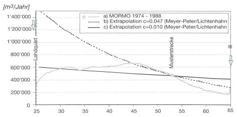
Bild 9. Vergleich der mit dem numerischen Modell berechneten Geschiebefrachten zwischen den Mündungen der Landquart und der III und der Extrapolation mit der J-Formel mit verschiedenen Abriebbeiwerten (Raumgewicht 20 kN/m³).
