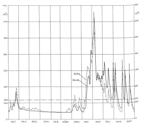
Bild 1. Ganglinie der Abflüsse (Tagesmittel) des Rheins in Felsberg im heutigen Normjahr (ausgezogene Linie) sowie gemäss eines als «realistische Variante» bezeichneten Szenarios für das Jahr 2050 (strichlierte Linie). Die Schwelle von 120 m³/s entspricht dem Schluckvermögen des angenommenen Laufwerks.
