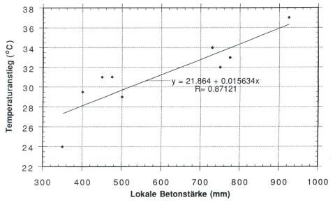
Bild 5. Beziehung maximale Abbindetemperatur - Betonstärke.
