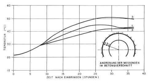
Bild 4. Typischer Temperaturverlauf im frisch eingebrachten Beton.
