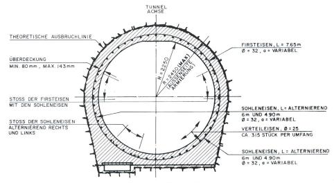
Bild 2. Typische Anordnung der Armierung für  $\emptyset$  = 32 mm radial.
