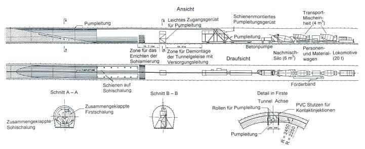
Bild 6. Betonierzug, Transporteinheit und allgemeine Anordnung von Schalung und Betoniereinrichtung im Tunnel.
