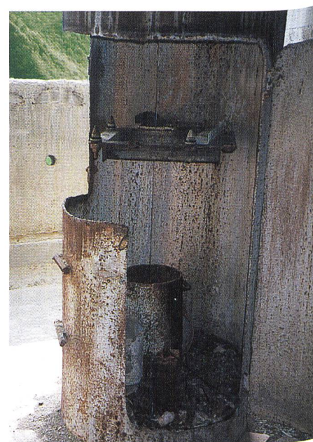
Bild 2. Detail eines Lotes zur Verformungsmessung.
