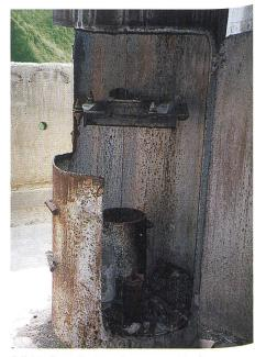
Bild 2. Detail eines Lotes zur Verformungsmessung.
