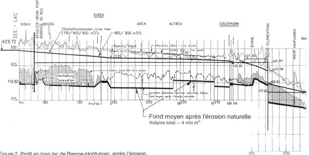
Figure 2. Profil en long lac de Bienne-Hohfuhren, après l'érosion.
