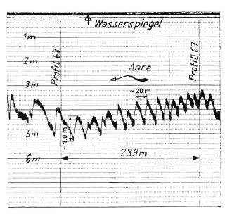
Figure 5. Fond du lit de l'Aar à Selzach, caractérisé par une morphologie de dunes.
