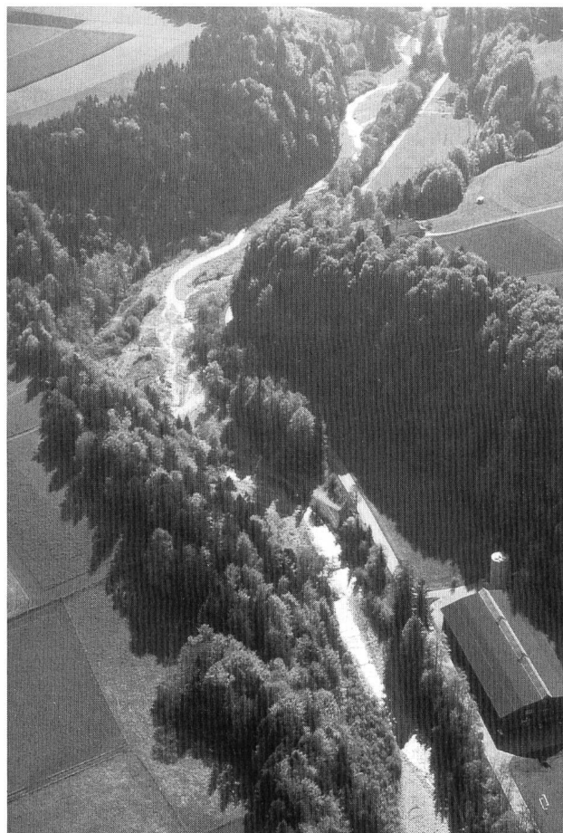
Figure 16. Le Schwarzwasser en aval de Rüschegg-Graben. Le cours d'eau n'occupe plus que la moitié de la vallée. Le rehaussement du lit va mettre en danger les zones agricoles et artisanales, ainsi que la route (Photo J. Cl. Bersier, Fribourg).
