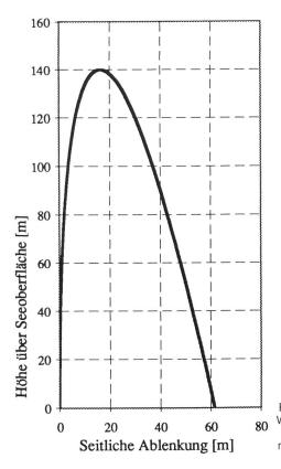
Berechnete Flugbahn eines Wassertropfens des Jet d'Eau mit Seitenwind.
