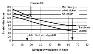
Bild 1. Annahmen für Seitenwindeinfluss auf Strahlhöhe.
