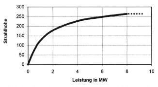
Bild 2. Annahmen für die Abhängigkeit der Strahlhöhe von der Pumpenleistung.
