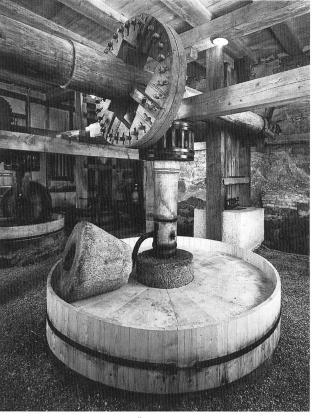
Bild 1. Der 1988 restaurierte Öleraum der Grabenöle Lüterswil mit der Flachsreibe im Vordergrund.
