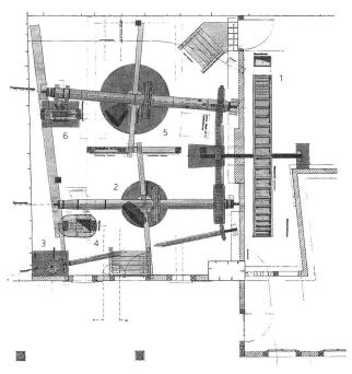
Bild 2. Grundriss des Öleraumes mit dem Wasserrad (1), der Samenreibe (2), der Ölpresse (4), der Flachs- oder Hanfreibe (5) und der Knochenstampfe (6).
