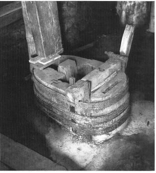
Bild 4. Der Ölpressstock, die Ölpresse oder die Öltrotte vor der Restaurierung.
