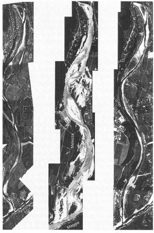
Bild 3. Luftbildaufnahmen des rund 4,3 km langen Abschnittes der Melezza in der Alluvionsebene vor dem Zusammenfluss mit der Maggia. Die Aufnahmen stammen aus den Jahren 1966/68 (links), 1978 – unmittelbar nach dem Hochwasserereignis – (Mitte) sowie 1996 (rechts). Fliessrichtung jeweils von oben nach unten.
