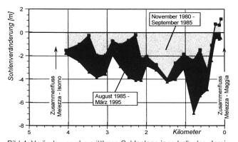
Bild 4. Veränderung der mittleren Sohlenlage innerhalb des dominanten Einzelgerinnes im Flussbett der Melezza in der Zeit von 1980 bis 1995. Im Zusammenflussbereich von Melezza und Maggia erfolgte eine grössere Abtiefung kurz nach dem Hochwasser von 1978 und damit noch vor der ersten Sohlenaufnahme vom November 1980.
