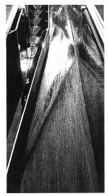
Bild 8. Stosswellen in Kanalkontraktion mit Blick in Fliessrichtung a) Diffraktoren ① und ② und b) unverbaute Kontraktion.  $F_o$  = 4,  $L_K$  = 2080 mm und  $\Theta$  = 5,5° (1-15, 2-15).
