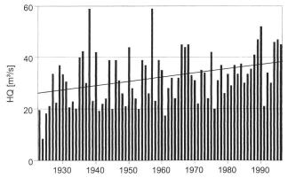
Bild 2. Gürbe-Belp (1923–1996): Signifikante Zunahme der Jahreshochwasserspitzen.
