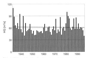
Bild 4. Weisse Lütschine-Zweilütschinen (1933–1996): Jahreshochwasserspitzen ohne signifikanten Trend.
