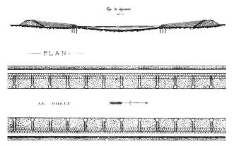
Figure 2. Situation et profil-type de la 1<sup>re</sup> correction du Rhône.
