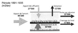
Figure 5. Bilan estimatif des transports solides entre Chippis et Branson.
