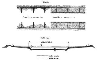
Figure 6. Aménagements de la 1<sup>re</sup> et de la 2<sup>e</sup> correction du Rhône.
