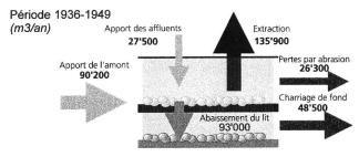
Figure 8. Bilan estimatif des transports solides entre Chippis et Branson.
